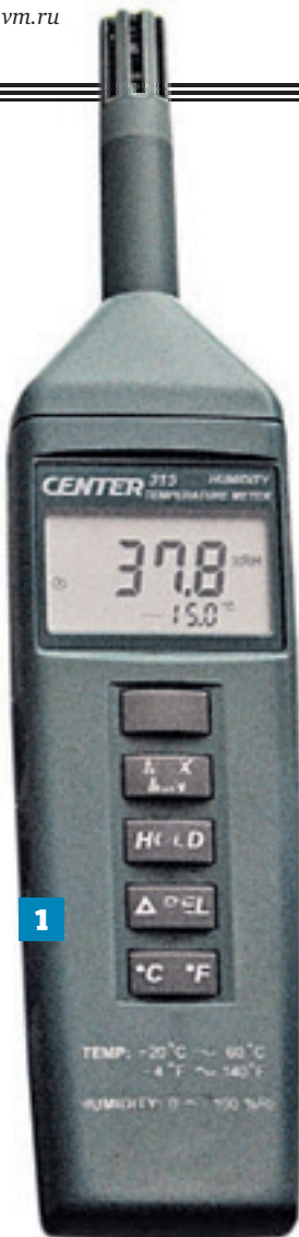
► Термогидрометр (1) Техник лаборатории микроклимата метро Екатерина Гаврилова измеряет запыленность станции «Отрадное» аспиратором (2)
