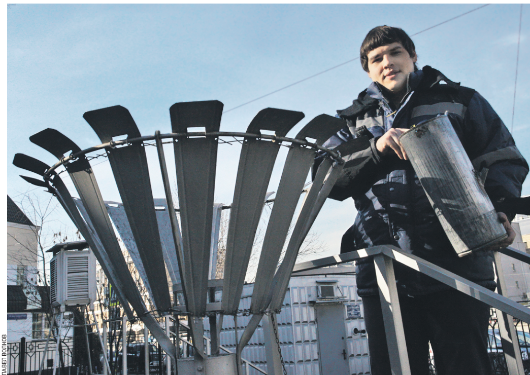
19 марта 16:39 Студент Туапсинского метеорологического техникума Андрей Петров, проходящий практику на станции «Балчуг», снимает показатели с осадкомера Третьякова
