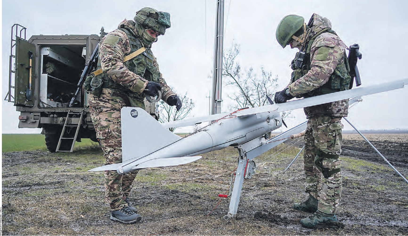
6 февраля 10:04 Бойцы ВС РФ во время совместной работы многофункционального беспилотного комплекса «Орлан-10» и самоходной гаубицы «Мста-С» в зоне СВО. С помощью БПЛА устанавливаются местонахождение объектов врага на правом берегу Днепра и корректируются стрельбы. Расчет гаубицы уничтожает цели
