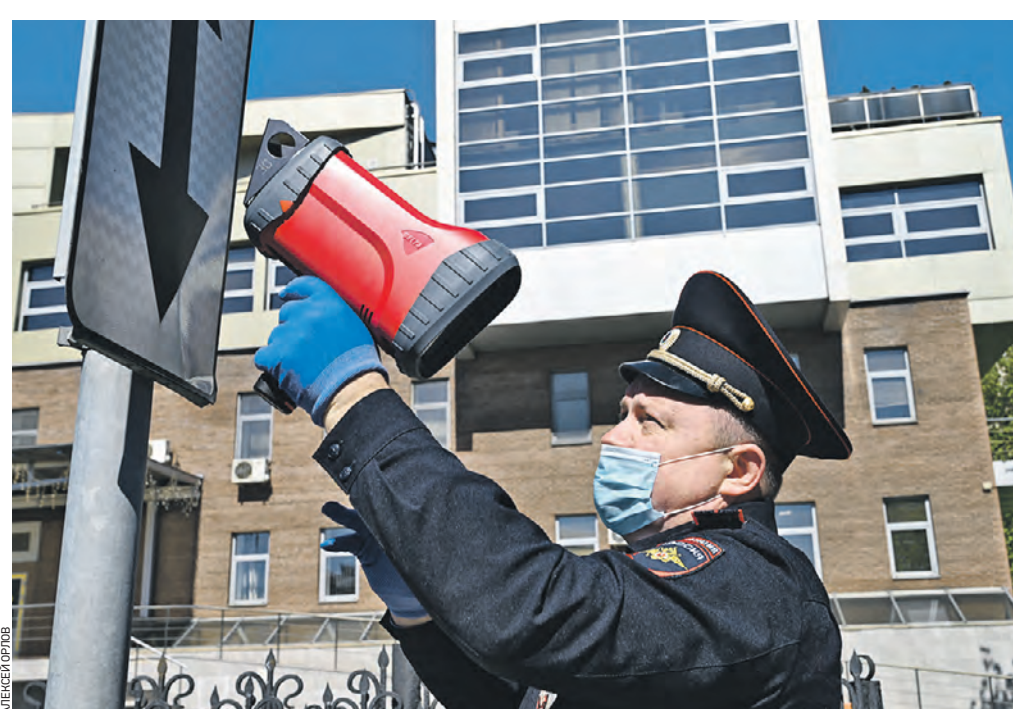
Вчера 10:25 Госавтоинспектор дорожного контроля ГИБДД УВД ЦАО Григорий Кашарайло демонстрирует работу ретро-рефлектометра. Он измеряет светоотражаемость дорожного знака
