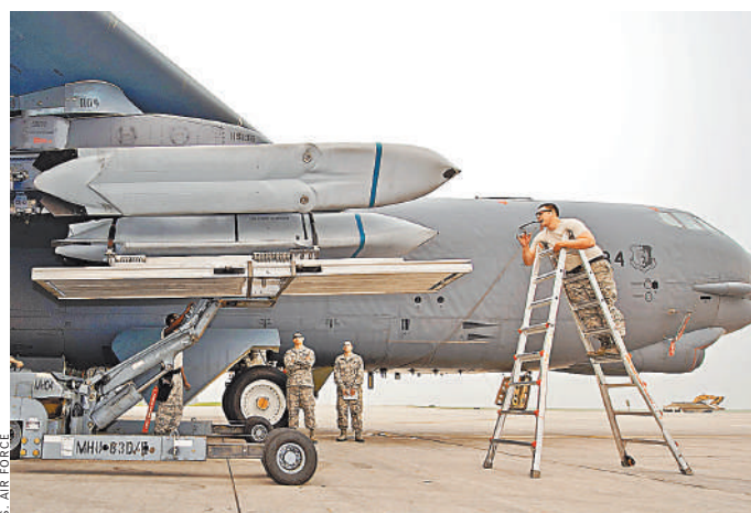
Дальность полета ракеты JASSM около тысячи километров. Она имеет малую радиолокационную заметность.
