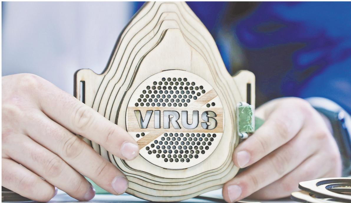
В Татарстане научились изготавливать защитные маски из фанеры. Конструкцию разработал педагог Дома детства и юношества города Мамадыш Радик Гурьев. Маска, детали которой вырезаны на лазерном станке, оснащена съёмным дозатором с клапаном. В него вставляется обычный ватный диск, который можно менять много раз. Оригинальные маски изобретатель бесплатно раздаёт своим коллегам.
