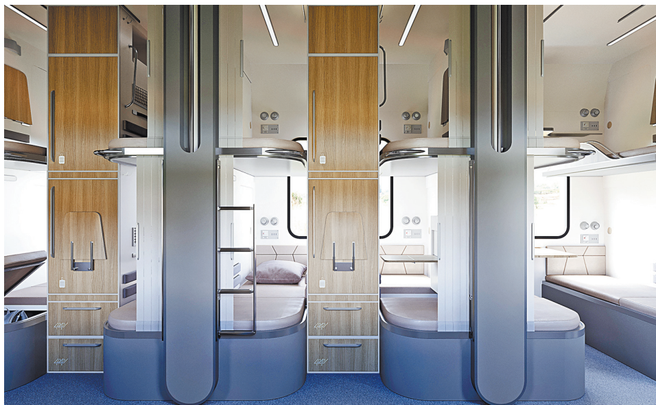
В традиционном купе посередине появится перегородка, которую можно открыть.
