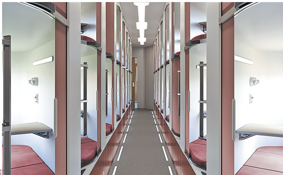
Если полки расположить «елочкой», у каждого места будет небольшой столик.
