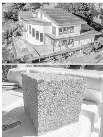
Хембетон (Hempcrete) — это экологичный строительный материал из смеси конопляной крошки и извести. Он лёгкий, отлично держит тепло и регулирует влажность, с ним просто работать, и он подходит для большинства климатических условий. Стены такого
