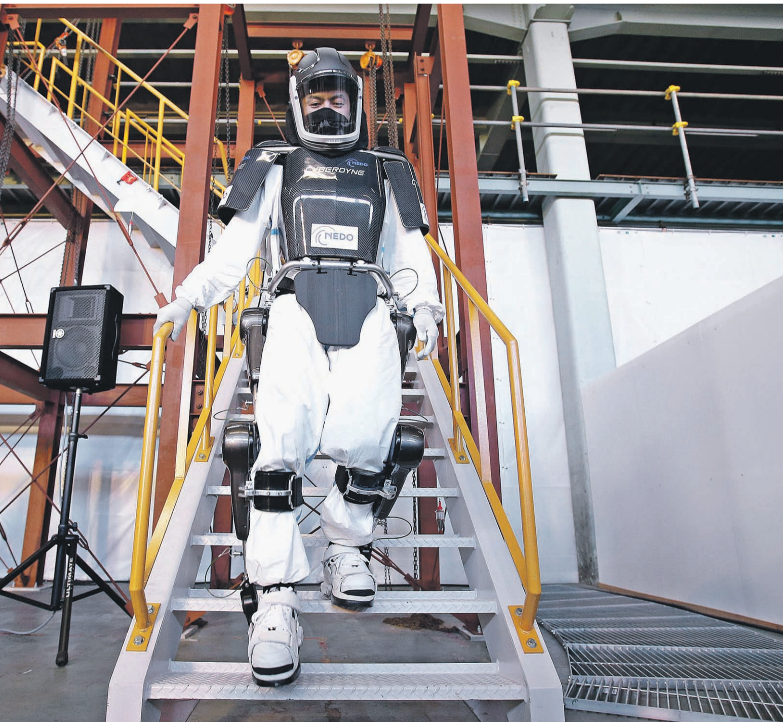
Экзоскелет компании Cyberdyne приводится в действие электрическими импульсами, испускаемыми мускулами человека
