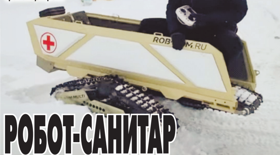
Робот-санитар изобретателя Андрея Золотова оснащен подъемным кузовом и транспортером.
