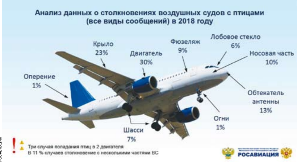
Анализ данных о столкновениях воздушных судов с птицами (все виды сообщений) в 2018 году
