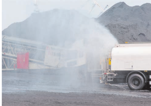
Специальные установки обеспечивают постоянный полив штабелей с углем.
