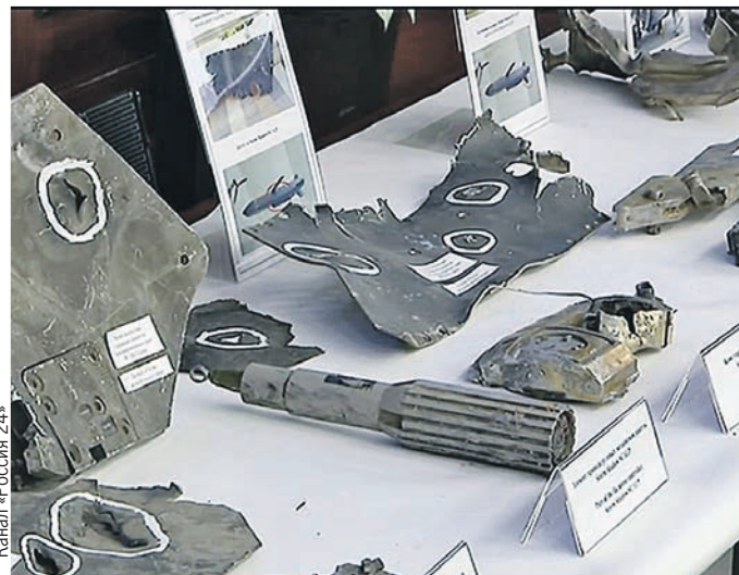
Фрагменты сбитых в небе Сирии американских ракет имеют характерные следы от поражающих элементов ЗРК.
