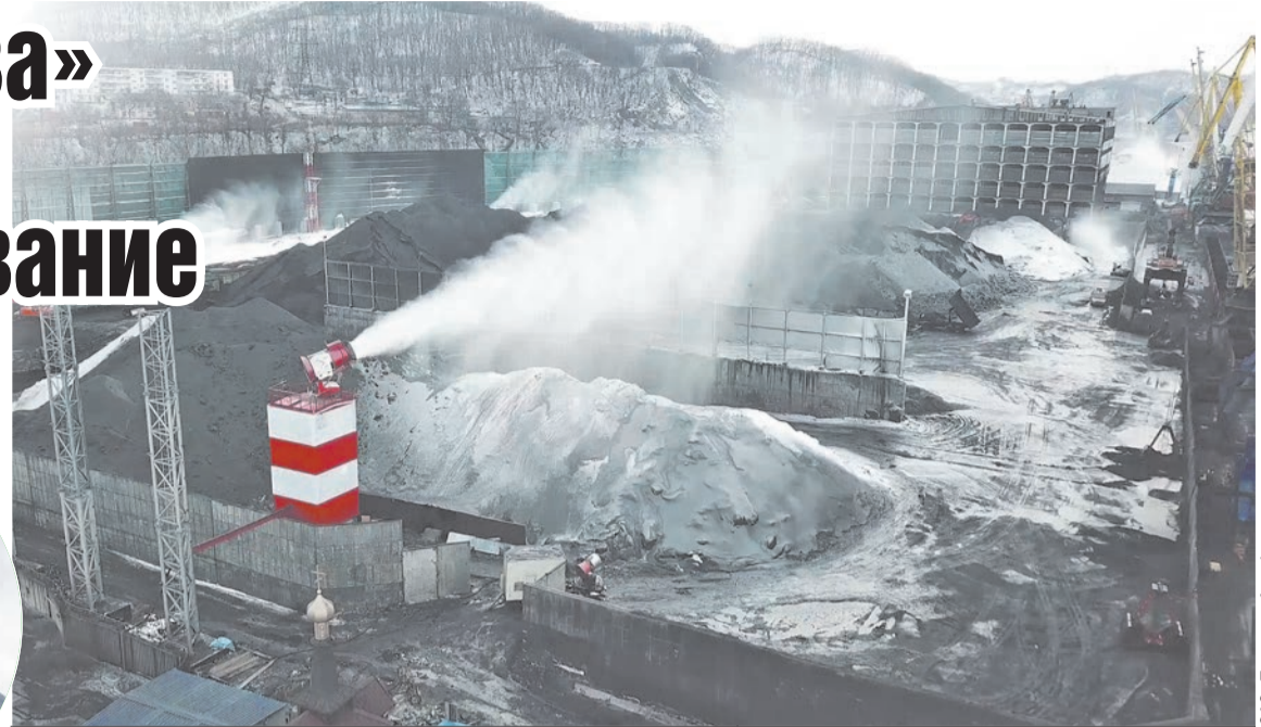
Водяная пушка обладает высоким эффектом пылеподавления. Это одна из самых мощных на Дальнем Востоке установок.
