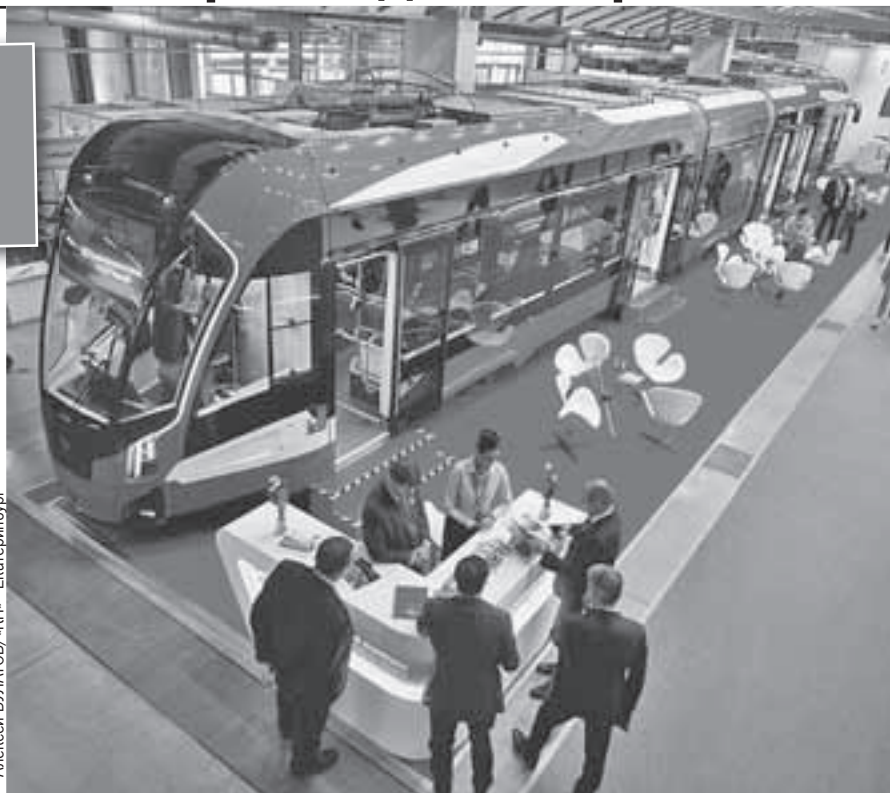
Вместимость супертрамвая 205 человек, сидячих мест - 52. Длина - 27 метров. На 95% сделан из отечественных компонентов.
