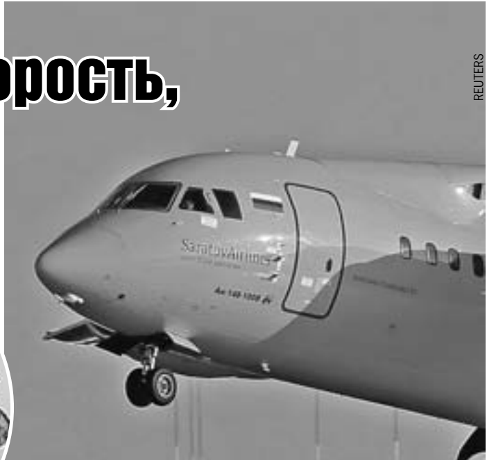
Так выглядит датчик скорости на носу лайнера, который мог отказать из-за обледенения.
