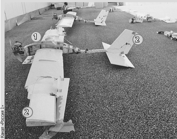
Минобороны России показало дроны террористов, которые удалось приземлить. Их электроника обмотана зеленым скотчем. Фюзеляж собран из досок ящика из-под фруктов (1). Крылья и хвост - из фанеры и пенопласта (2).
