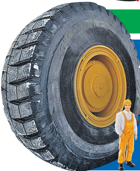
ДИАМЕТР КАЖДОГО ИЗ ВОСЬМИ КОЛЕС - 4 МЕТРА, А ВЕС - БОЛЬШЕ 5 ТОНН
