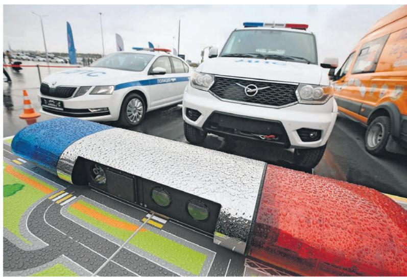
Первые прототипы сигнальных балок с встроенными камерами ГИБДД показала еще в 2019 году в Екатеринбурге
