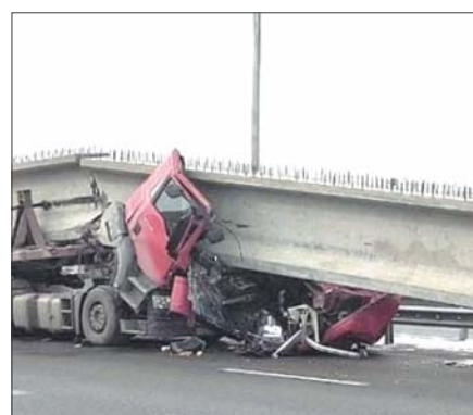
Вероятно, балка съехала на кабину фуры при резком торможении.
