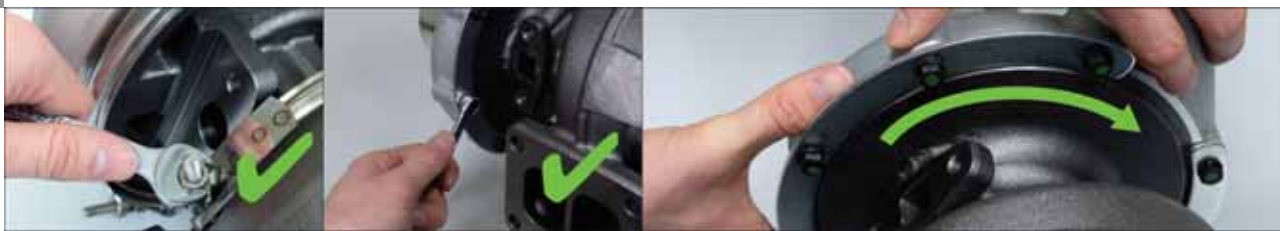
Для юстировки разрешается ослабить стяжные хомуты и болты
