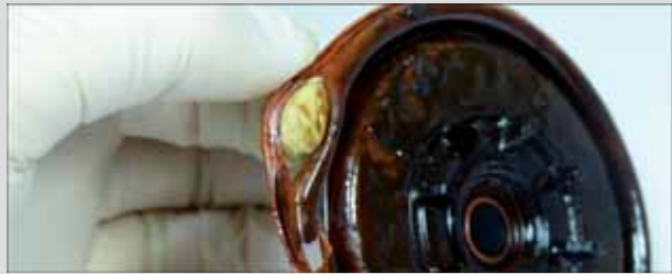
Разрыв мембраны клапана PCV
