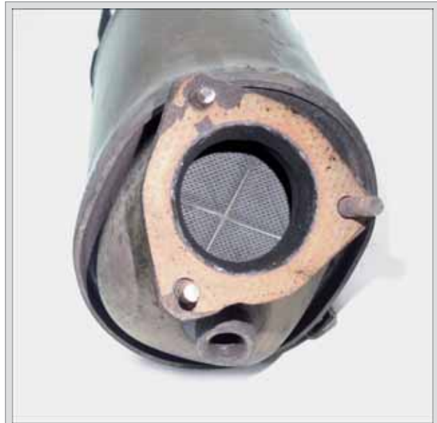
Демонтированный сажевый фильтр
