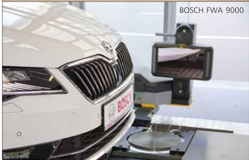
Стенд для калибровки систем помощи водителю
