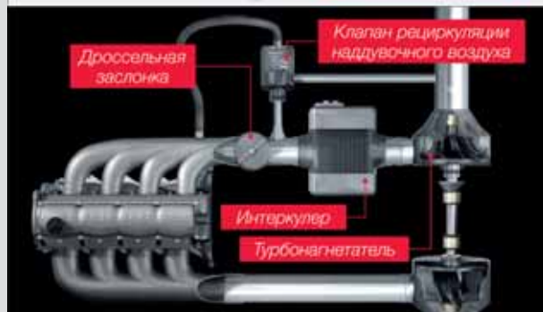
Клапан рециркуляции наддувочного воздуха с пневматической регулировкой вакуумом
